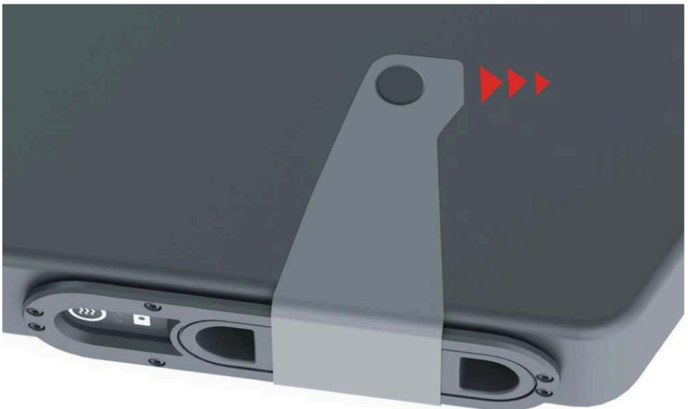
La languette de sécurité s'ouvre en tirant sur la languette vers la droite. L'aimant fixé est ainsi retiré de son dispositif de déverrouillage. Étant donné que la fermeture intégrée dans le matelas de brancard ne présente la sortie pour l'aimant que dans une seule direction, la languette ne peut être ouverte que dans cette direction et de cette manière. Toute traction dans d'autres directions (par exemple uniquement vers le haut) n'est donc pas efficace.
