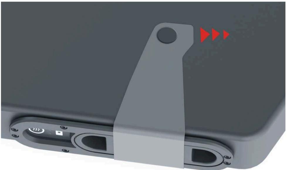
Die Sicherheitslasche wird geöffnet, indem man an der Lasche nach rechts zieht. Dadurch wird der fest sitzende Magnet aus seiner Entriegelung gezogen. Da der in der Tragenauflage integrierte Verschluss den Ausgang für den Magneten nur in eine Richtung aufweist, kann die Lasche nur in diese Richtung und auf diese Art und Weise geöffnet werden. Jegliches Ziehen in andere Richtungen (z.B. nur nach oben) ist daher nicht zielführend.
